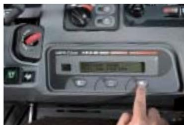
1 Stecken Sie den roten Schlüssel in das Zündschloss und drücken Sie anschließend den rechten Menüschalter mit dem Bildschirmsymbol.
