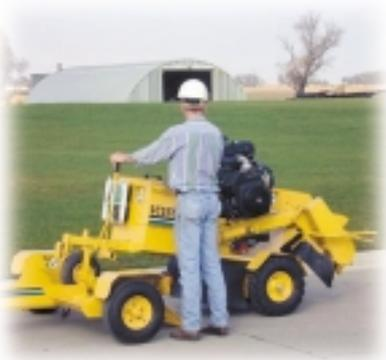
**Die SC252 mit abnehmbarer Vorderdeichselbaugruppe** ermöglicht verschiedene Vorderradoptionen. Innovative Konstruktionsmerkmale und die kleine Breite der SC252 sorgen für einen bequemen Transport der Anlage.
