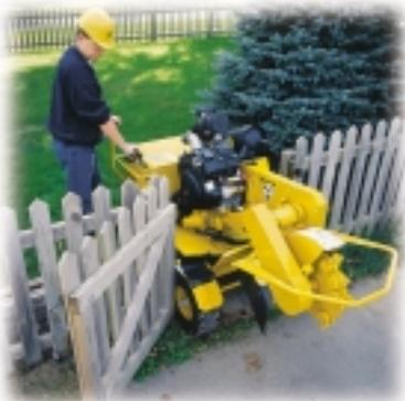
**Mit einer Breite von nur 89 cm** passt die Baumstumpffräse SC252 durch die meisten Standardtore und engen Öffnungen. Ferner ist die Anlage auf engstem oder eingeschlossenem Arbeitsraum manövrierfähig.
