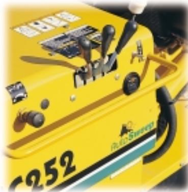
**Das übersichtliche Schaltpult** sorgt für ein schnelleres Erlernen durch die Bediener und vermeidet Verwechslungen beim Betrieb der Maschine. Die hydraulischen Steuerungen tragen, mit einem Minimum an Verschleiß für die Maschine, zum Erreichen der besten Arbeitsergebnisse bei.
