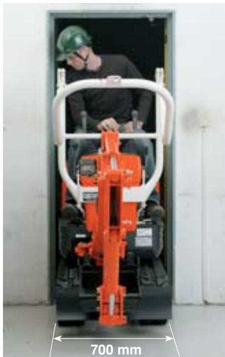
Bei der eingestellten Fahrwerksbreite von nur 700 mm kann der sich K008-3 durch fast jede Tür, z. B. in Innengebäuden bewegen.
